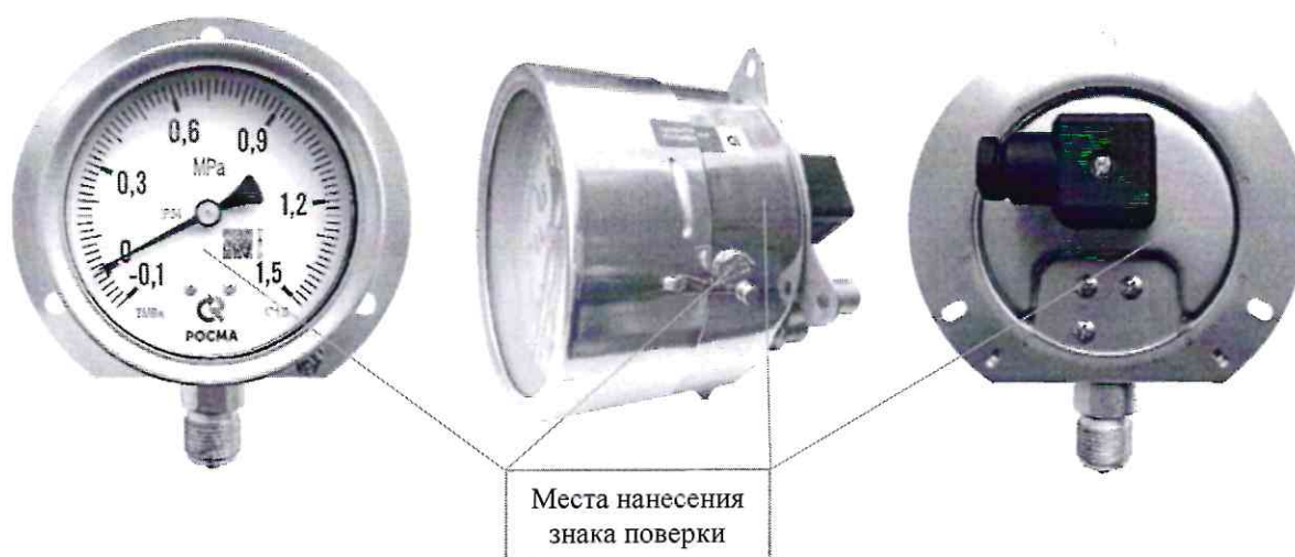
Рисунок 1 – Обозначение возможных мест нанесения знака поверки
